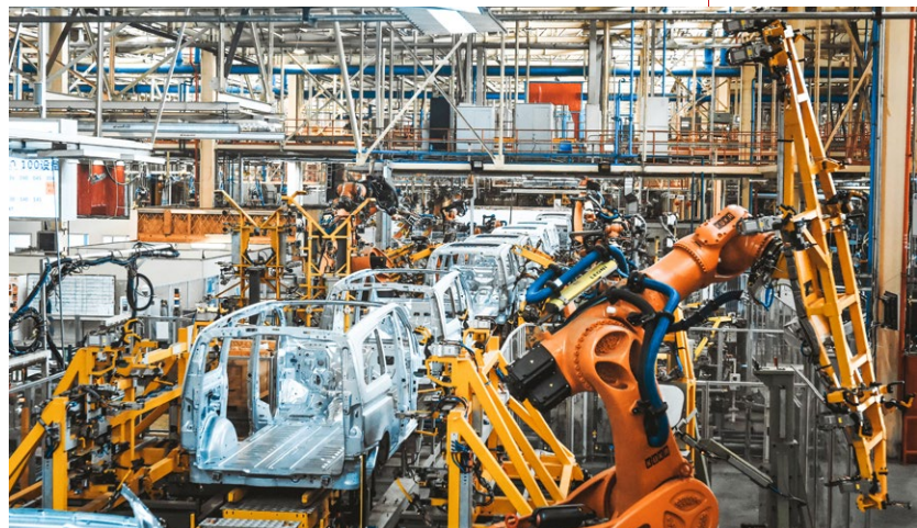
焊装生产车间，电焊机器人正在工作
