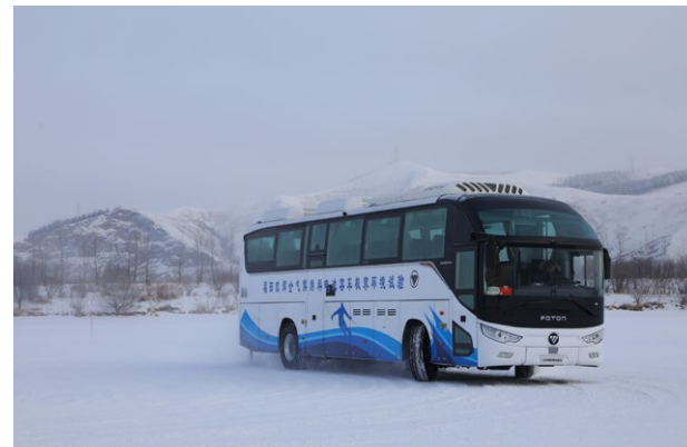
福田欧辉全气候氢燃料电池客车进行了极寒环境试验
