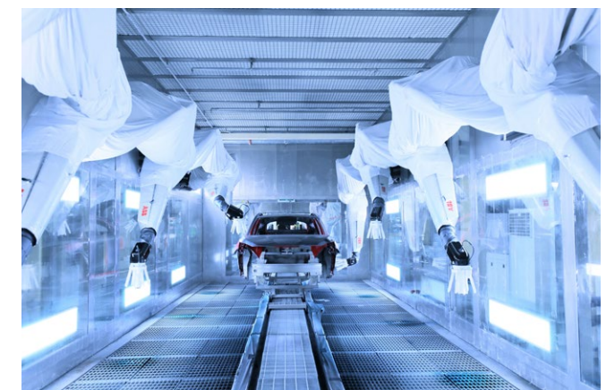
北汽蓝谷麦格纳工厂涂装生产线
