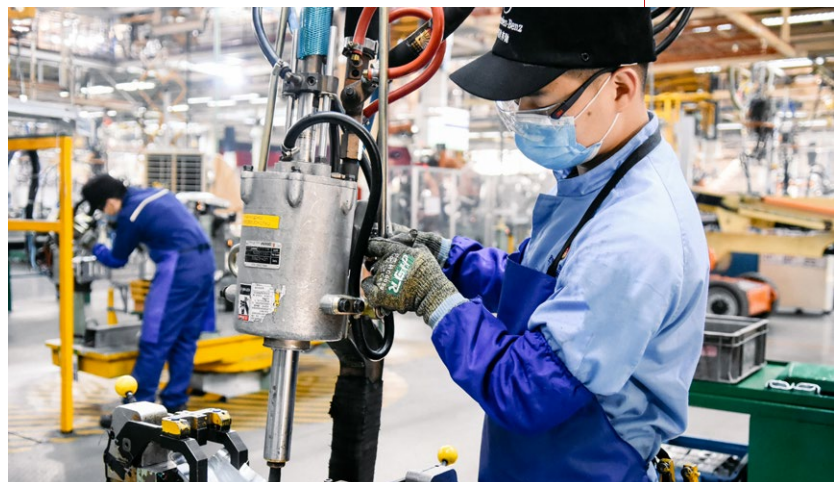
焊装车间左大梁线，作业人员正在进行左前内梁焊接
